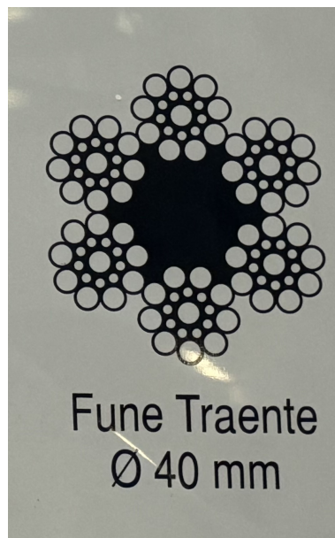
Abbildung 3: Schema des Querschnitts des Stahlseils laut Aushang an der Bergstation. Der Außendurchmesser soll 40 mm betragen. Die weiß dargestellten Anteile sind aus Stahl.
